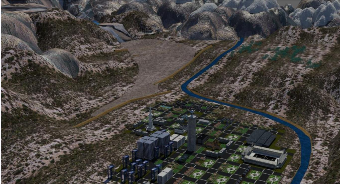
**Herramienta DFS propone conocer a través de simulación el área de inundación y posteriormente poder tomar decisiones para construir medidas de mitigación como muros de contención, de desviación, depresores de energía, entre otras.**
